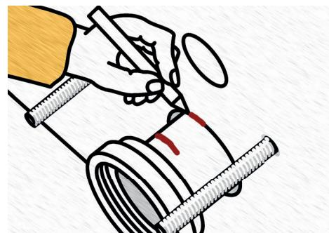
Rúru vytiahnite z WC a zasuňte ju do hrdla v podomietkovom module. Opäť si urobte značku – v rovine so stenou (rovnaký postup platí pre rúrkou na prívod vody).
