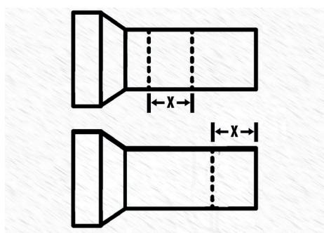
Zmerajte si dĺžku medzi dvomi značkami (rozmer X). Túto mieru potom naneste na koniec rúry (rovnaký postup platí pre rúrkou na prívod vody).
