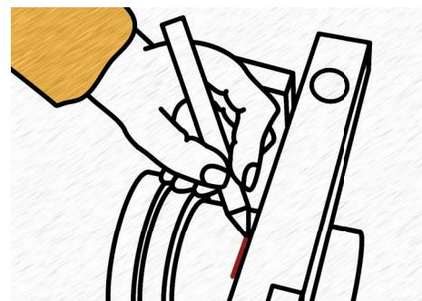
Pripravte si rúrkou na prívod vody a odpadovú rúru. Zasuňte rúru na hrdlo WC misy. Priložte vodováhu (alebo iný rovný predmet) a urobte si na rúre značku (rovnaký postup platí pre rúrkou na prívod vody).
